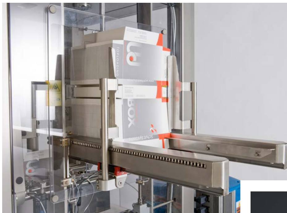
Het aangedreven plano kartonmagazijn van de F111 is op ergonomische werkhoogte
